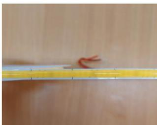
Светодиодная лента серии **COB-G24-400xx-5mm** представляет собой гибкую плату, на каждом метре которой смонтировано 400 кристалла, равномерно залитых люминофором. Для удобства монтажа на обратной стороне ленты предусмотрено клейкое основание. Лента поставляется в катушках по 5 м.
