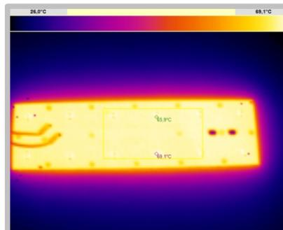
Термограмма, модуль NEO-L-12XL-1s2x6 ток 350 мА, Ta = 25°C, установившийся тепловой режим, без радиатора.
