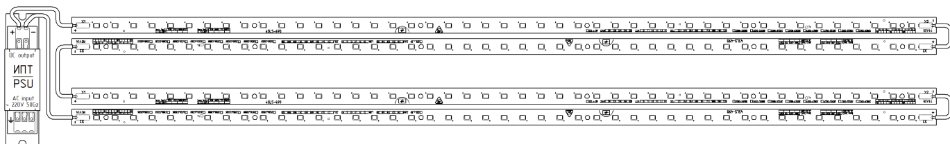
P.2 Последовательное включение / Serial wiring of LED modules
