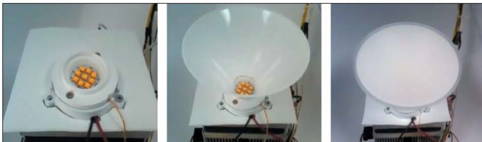
Рис. 1. Белые светодиоды, пластиковый конус-рефлектор и четырехдюймовый диффузор из поликарбоната
