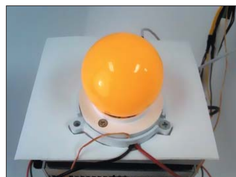
Рис. 4. Лампа с «дистанцированным» люминофором
