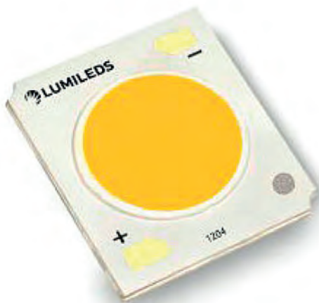
Серия LUXEON CoB Core Range 1204 (Gen 3), LES 13 мм. Мощность 15–30 Вт, эффективность до 160 лм/Вт
