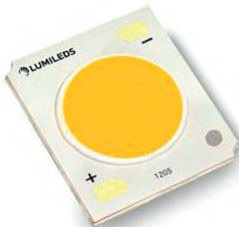
Серия LUXEON CoB Core Range 1205 (Gen 3), LES 13 мм. Мощность 20–40 Вт, эффективность до 155 лм/Вт
