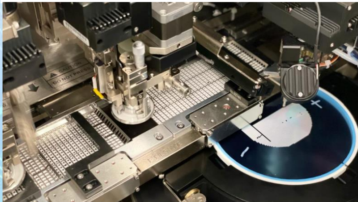
Монтаж кристаллов на рамку носитель
